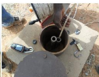
Mesure du niveau piézométrique à l'aide d'une sonde lumineuse sonore
