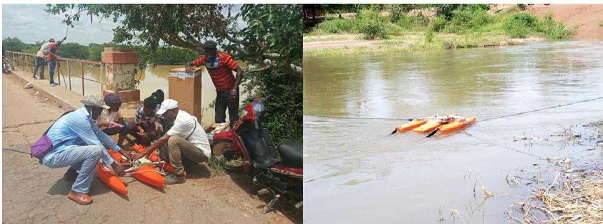
Photo 27 : mesure des débits à l'ADCP
