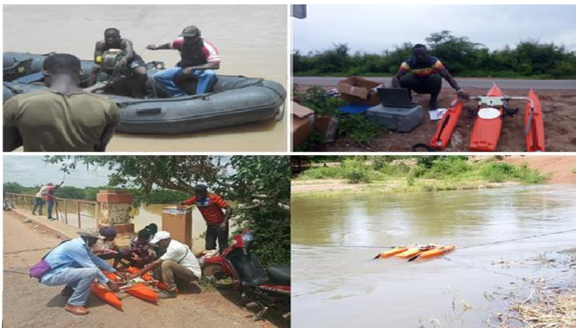
Photo 42 : Paramétrage de l'ADCP, jaugeage et mesure des débits
